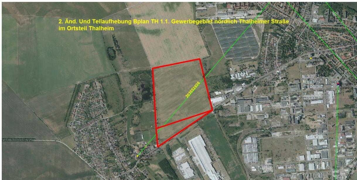
Man kann sich diese Telekommunikationslinie als einen horizontal über der Landschaft verlaufenden Zylinder mit einem Durchmesser von rund 30-60m (einschließlich der Schutzbereiche) vorstellen (abhängig von verschiedenen Parametern).
